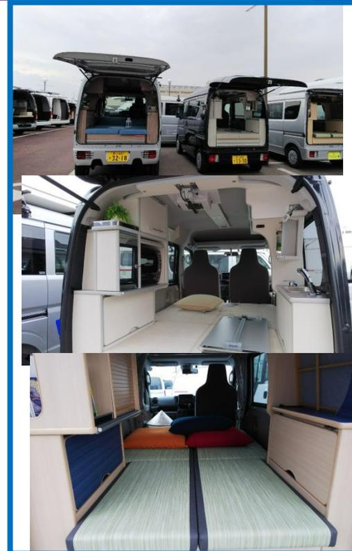
軽キャンパー 屋根上にソーラーパネル装備で、車内に電子レンジ、LED 照明天井灯、液晶テレビ装備。ミニシンクによる水回りも確保されている。
