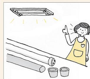
揺れによって、照明器具が落ちてくる危険があります。蛍光灯をすっぽり覆う専用チューブを利用することで、万が一蛍光灯が落ちて割れてもガラスが飛び散りません。
